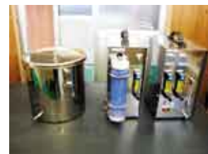
小型機器からのVOC放散量測定 (電子部品、基板、材料など)
