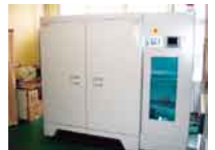
大型機器からのVOC放散量測定 (家電機器、パソコンなど)
