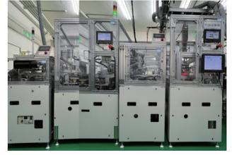
特性試験、樹脂コート、乾燥硬化
