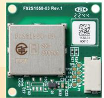
24GHz マイクロ波を使用したドップラーセンサー
