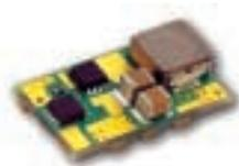
電子機器内の多様な電力供給要求に対応した分散化方式のPoint-of-load (POL) 電源として、非絶縁型DC-DCコンバータ「Senpaiシリーズ」8機種を開発いたしました。
