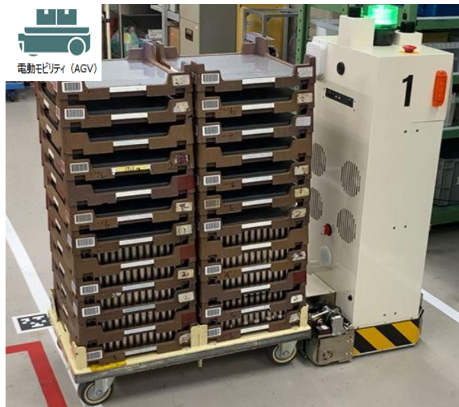
[高崎工場AGV連続走行実証実験]
