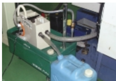
廃水溶性オイルの分離機 (FDKエンジニアリング)
