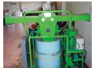
蛍光管破碎装置
