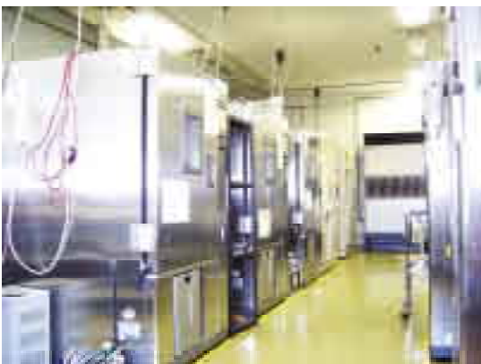
信頼性試験装置 (“環境にやさしい”製品の温度湿度加速試験)
