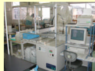
BOD 自動分析装置
